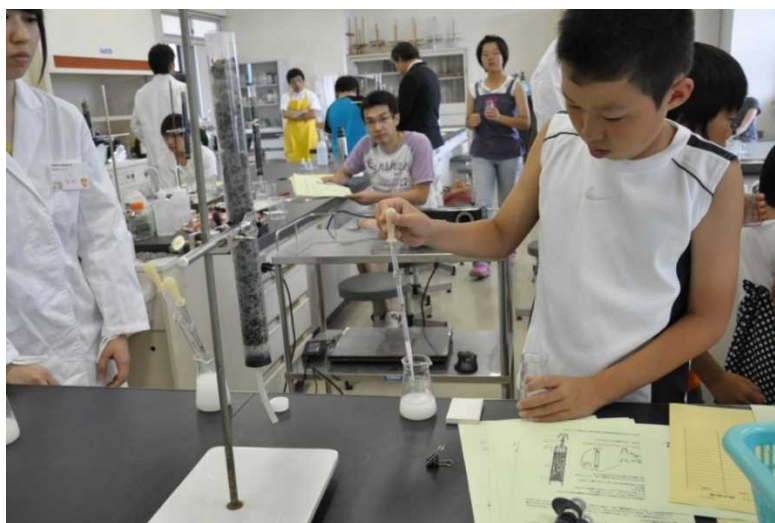
炭を用いて組み立てた浄化装置により種々の廃液を浄化している。
