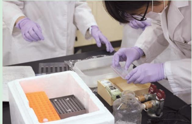
電気泳動に用いるゲルを専用の装置にセットしている様子。
