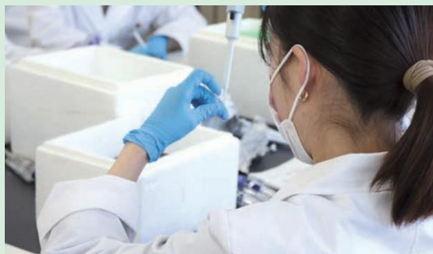
マイクロピペットを使って、極めて微量な試薬を分注している様子。
